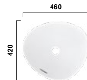
L4704E#MW Lavabo TA, asymétrique, blanc mat, 460mm, sans trou, avec trop-plein Lavabo TA asimmetrico, bianco opaco, 460 mm, senza foro per rubinetto, con troppopieno
