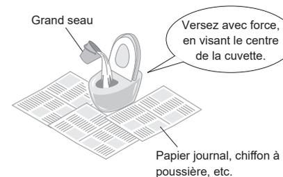
2. Si le niveau d'eau est bas après le rinçage, ajoutez plus d'eau. (Jusqu'à ce que le niveau d'eau cesse de monter.)
