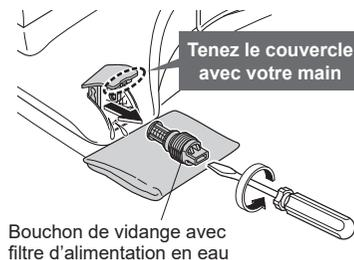
6. Lorsque l'évacuation de l'eau est terminée, réinstallez le bouchon de vidange avec le filtre d'alimentation en eau et le couvercle.
